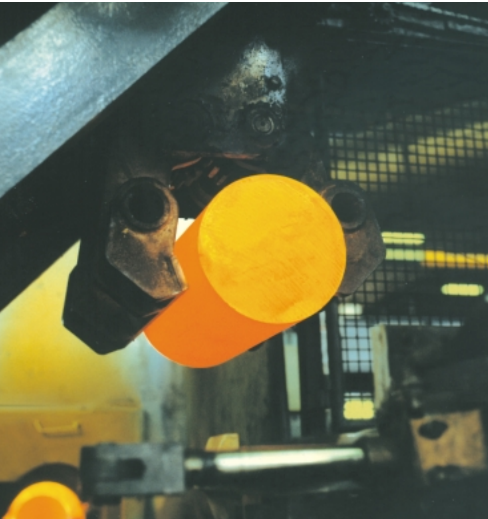
Transport eines erhitzten Messingblocks zum Strangpressen
